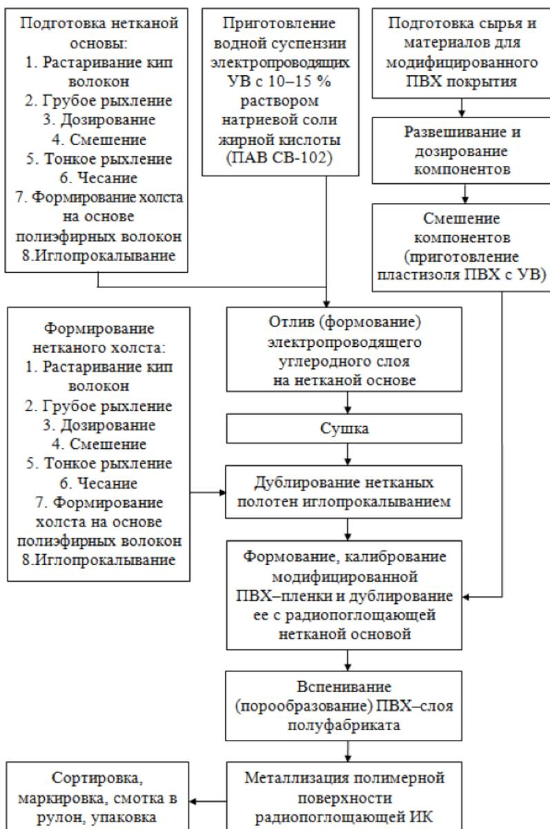
Рисунок 8 – Блок-схема производства радиопоглощающих ИК.
