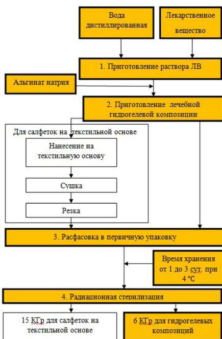
*Рисунок 1 - Технологическая схема производства медицинских изделий на предприятии «Колетекс»*
