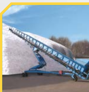
Конвейер ленточный передвижной КЛП-650 Mobile belt conveyor КЛП-650
